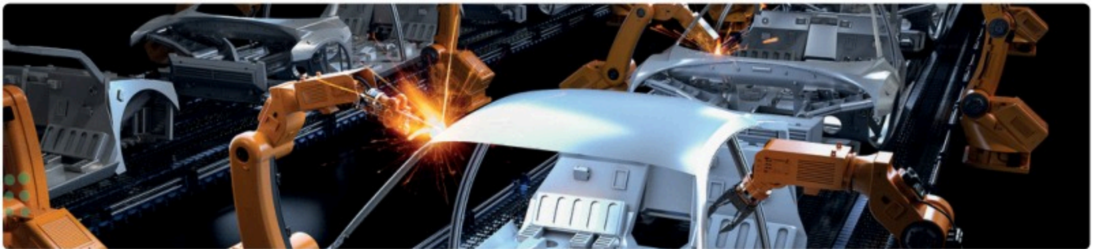
شكل 1.4: خط تجميع روبوتي في مصنع سيارات
