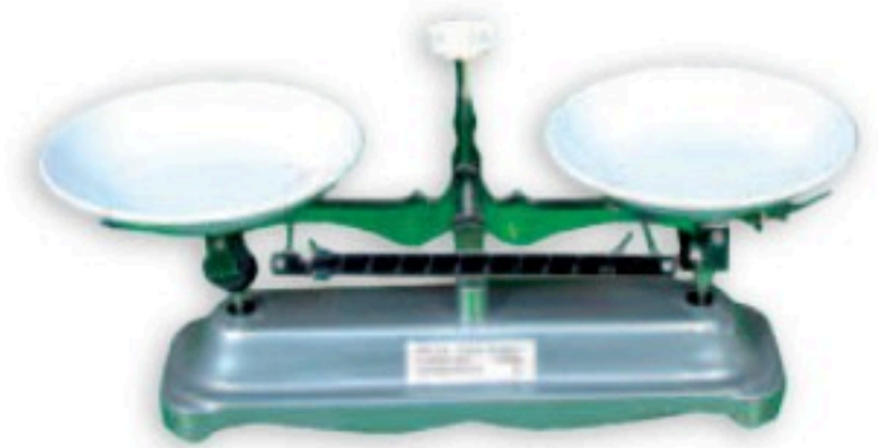
يستخدم الميزان ذو الكفتين لقياس الكتلة.
