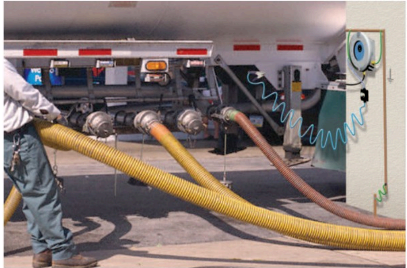
■ الشكل 13-3 سلك التأريض المتصل بصهريج نفط يمنع اشتعال بخار البنزين.
