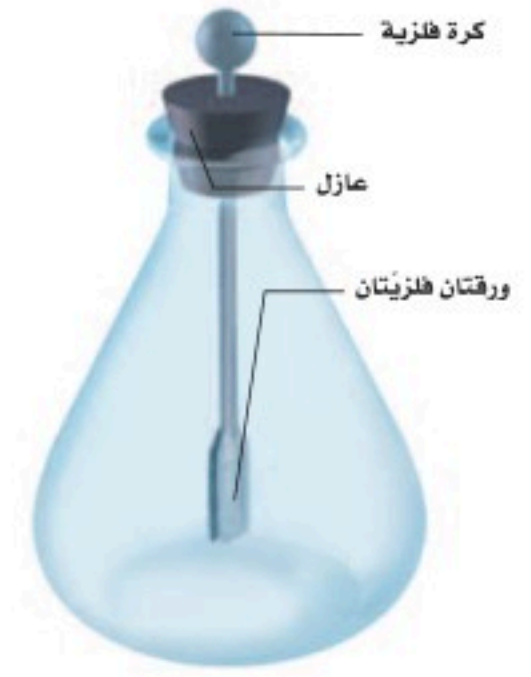
■ الشكل 2-8 الكشاف الكهربائي؛ جهاز يستخدم للكشف عن الشحنات الكهربائية. في الكشاف الكهربائي المتعادل تكون الورقتان معلقتين رأسياً بحرية، وتلامس إحداهما الأخرى.
