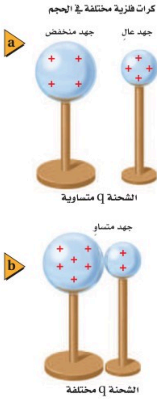
■ الشكل 12-3 تنتقل الشحنات من الكرة ذات الجهد الأعلى إلى الكرة ذات الجهد الأدنى عند تلاسهما، ويستمر انتقال الشحنات إلى أن ينعدم فرق الجهد بينهما.
