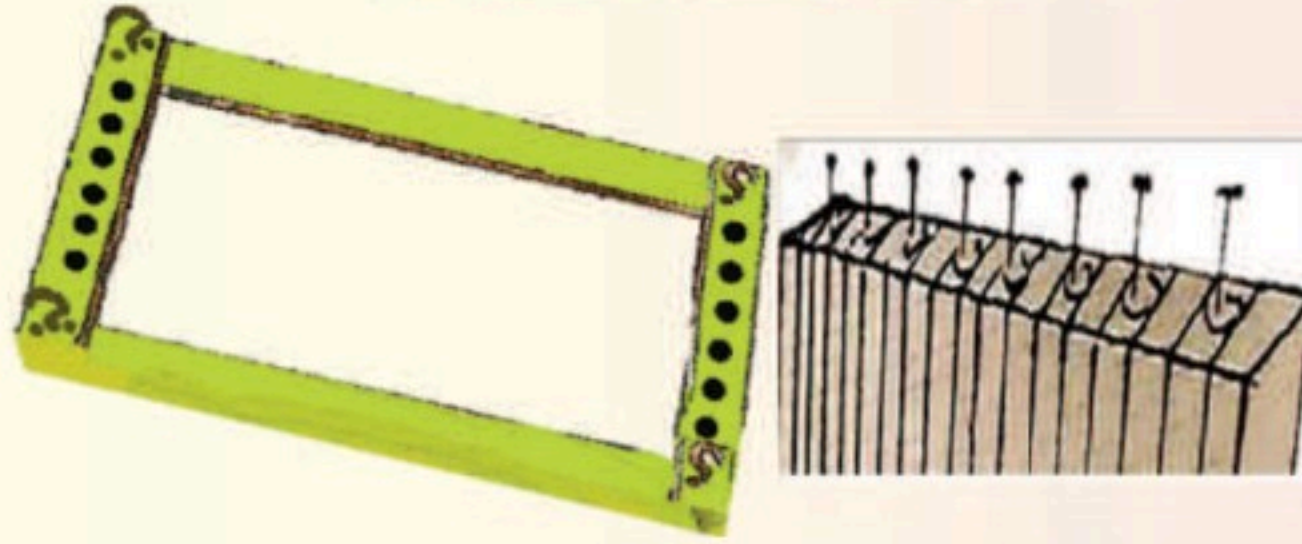
الشكل (٧٨): طريقة تثبيت المسامير على أضلاع النول.
