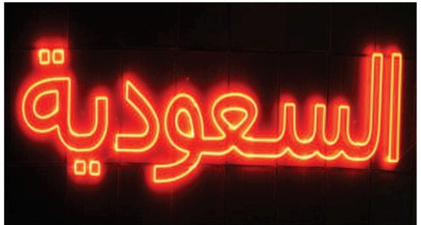
■ الشكل 1-6 تنتج التأثيرات الضوئية الملونة في إشارات النيون عن البلازما المضيئة المتكوّنة في الأنابيب الزجاجية.
