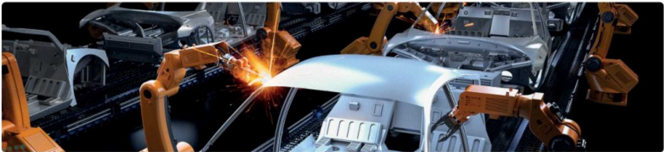
شكل 1.4: خط تجميع روبوتي في مصنع سيارات
