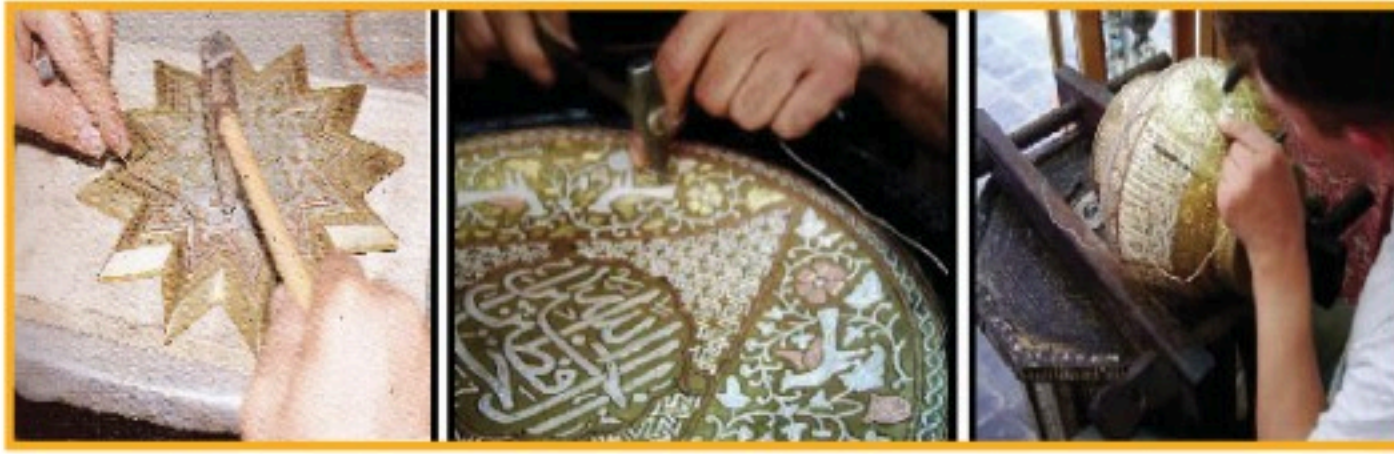
الشكل (٣٥): طريقة التكفيت
