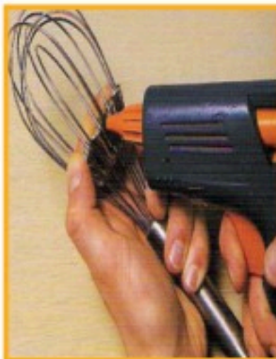
الشكل (٤٦): النوع الثاني ( لحام البارد باستخدام الصمغ ).
