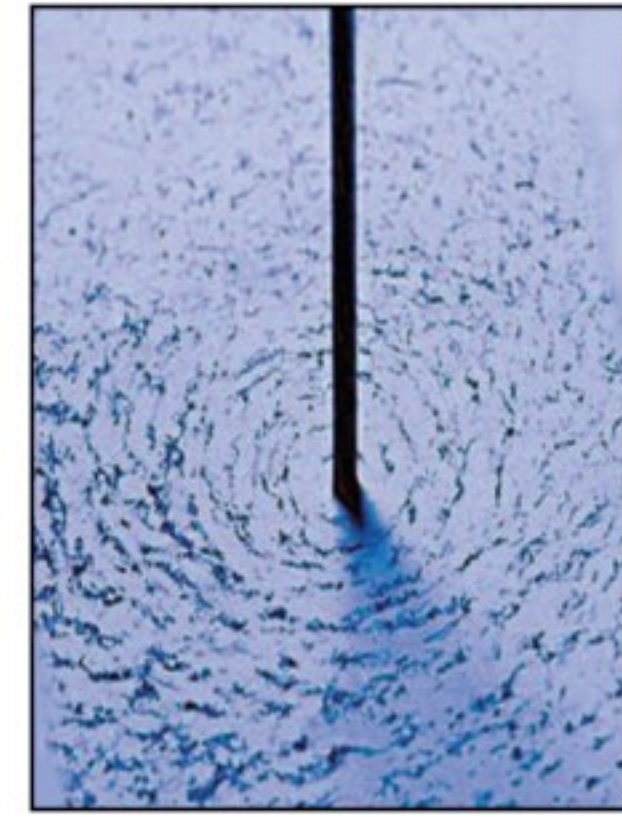
■ الشكل 9-6 يظهر المجال المغناطيسي حول سلك يمر فيه تيار كهربائي ويخترق قرصاً كرتونياً في صورة دوائر متحدة المركز من برادة الحديد حول السلك.
