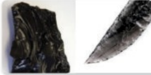
الشكل 1-22 استخدم التماس هيدمًا الزجاج غير المتبلور (الزجاج البركاني) لعمل رؤوس السهام والسكاكين. لأنه يكون حواف حادة عند كسره، يتكون الزجاج البركاني عندما تبرد الحمم البركانية بسرعة كبيرة.
