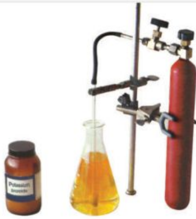
الشكل 3-2 التفاعل بين محلول أيونات البروميد وغاز الكلور هو تفاعل أكسدة، هنا تنتقل الإلكترونات من أيونات البروم إلى الكلور.
