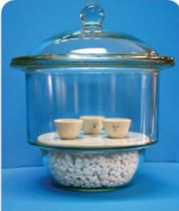
الشكل 7-1 يجفف كلوريد الكالسيوم الهواء من جزيئات الماء. كما يستعمل في المختبر في حفظ المواد الكيميائية من رطوبة الجو.
