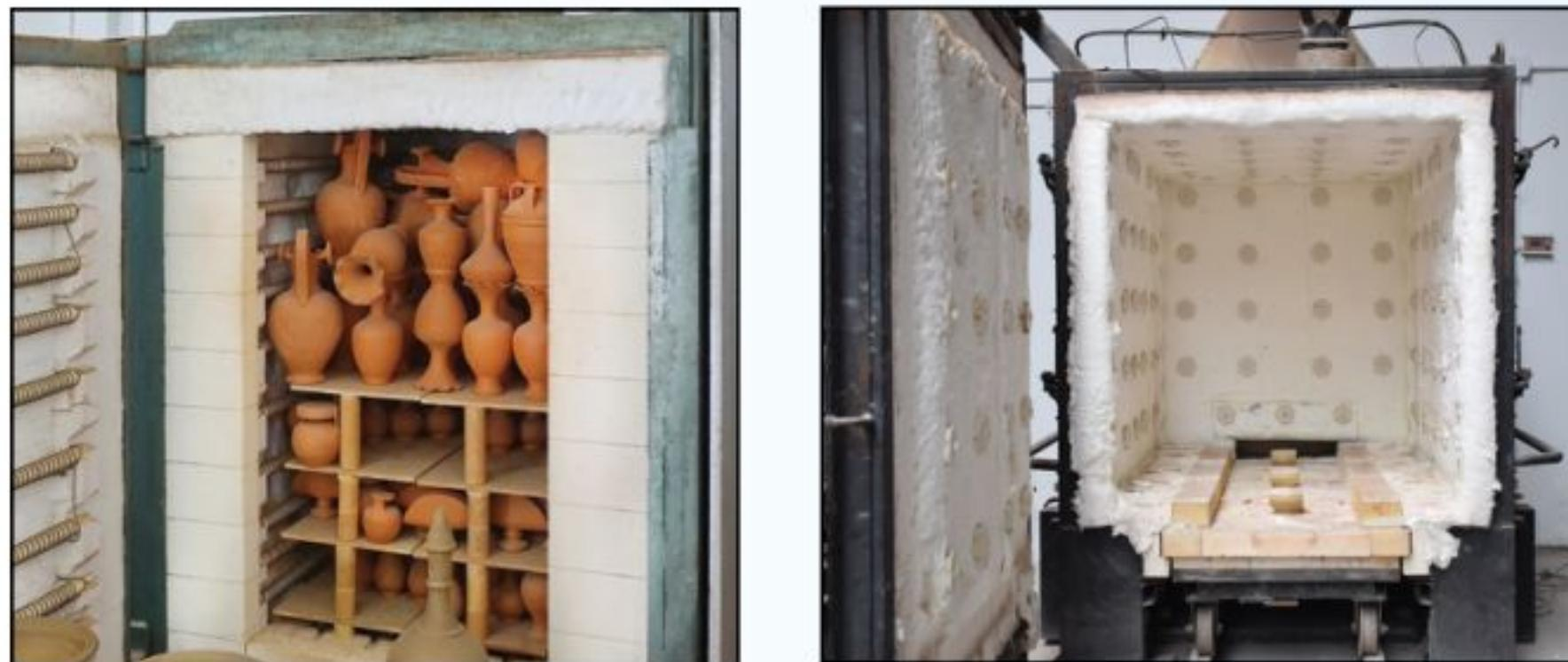
شكل (١٢٠) : الأفران الكهربائية.
