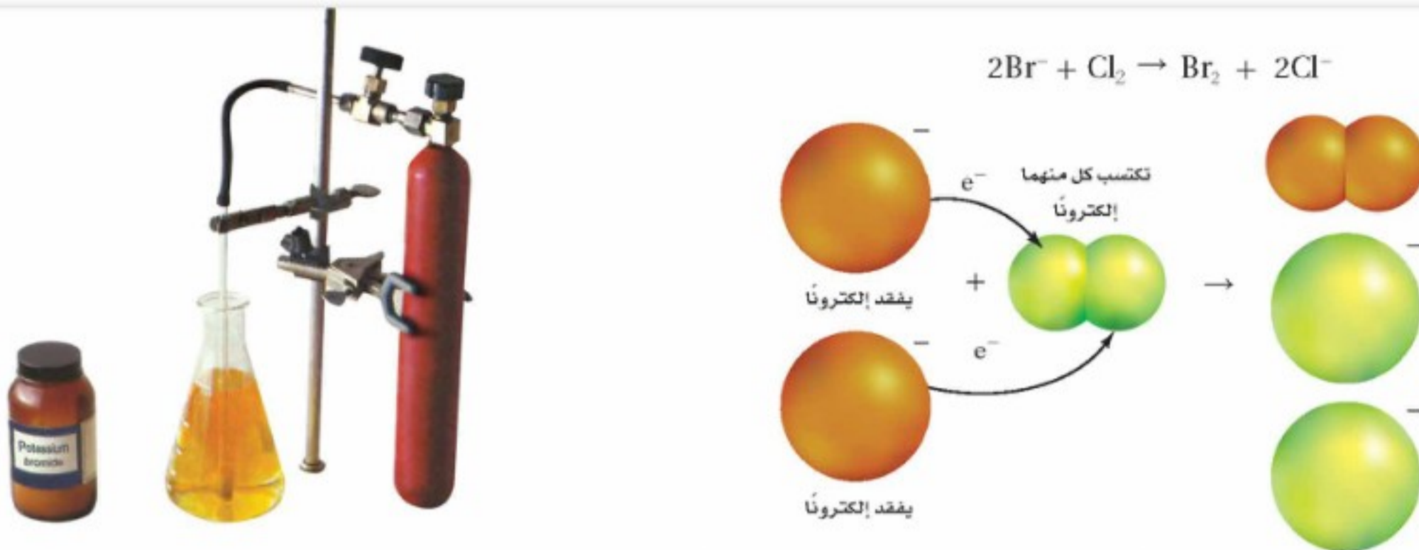
الشكل 2-4 التفاعل بين محلول أيونات البروميد وغاز الكلور هو تفاعل أكسدة، هنا تنتقل الإلكترونات من أيونات البروم إلى الكلور.
