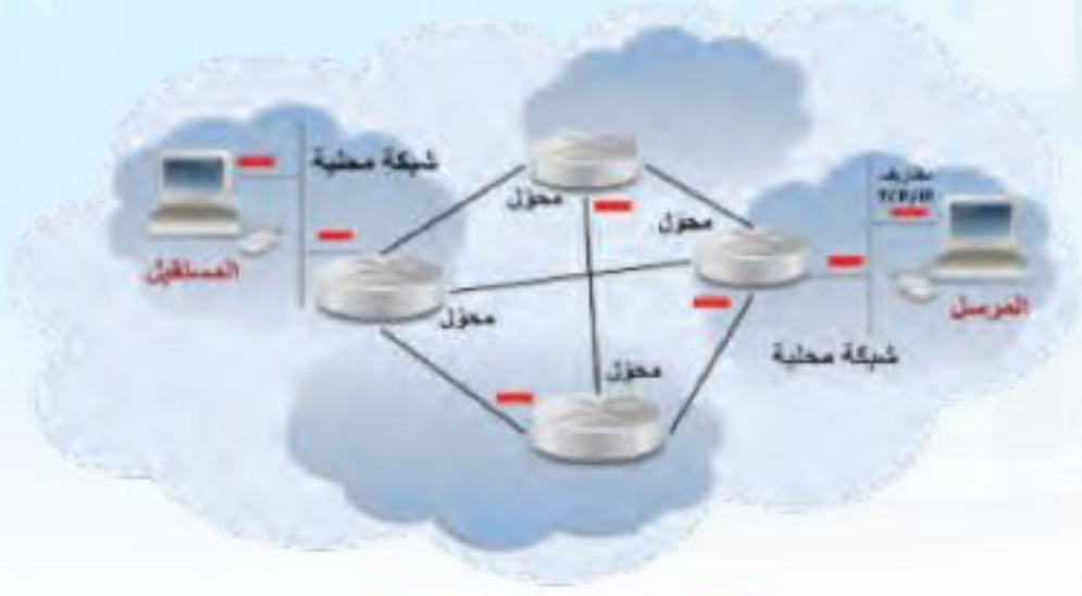
شكل (1-11) نقل وتبادل المظروف بين المحولات باستخدام مداوات (TCP/IP)
