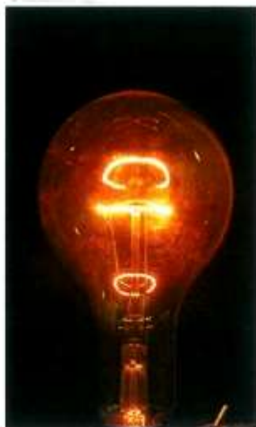
الشكل ١٤ يستخدم العنصر الانتقالي التنجستون في مضاييح الإنارة بسبب ارتفاع درجة انصهاره.
