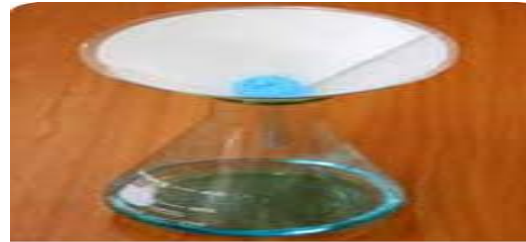
الشكل 13-2 عندما يمر المخلوط عبر ورقة الترشيح تبقى المادة الصلبة في الورقة في حين يخرج السائل المتبقى في الكأس .
